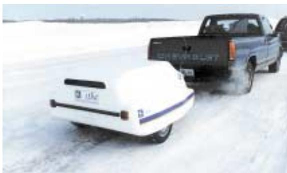
Remorque IMAG du STBA. Mesure de la glissance d'une chaussée aéronautique
